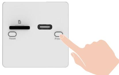
Nếu hết pin, hãy kết nối camera với ổ cắm điện bằng bộ đổi nguồn (5V 1A) để sạc (mua riêng).
